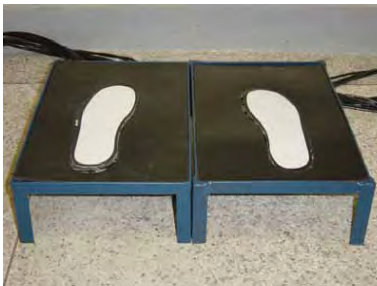
Figura 3.2 – Plataforma de força utilizada na pesquisa (TEODORO, 2006)
