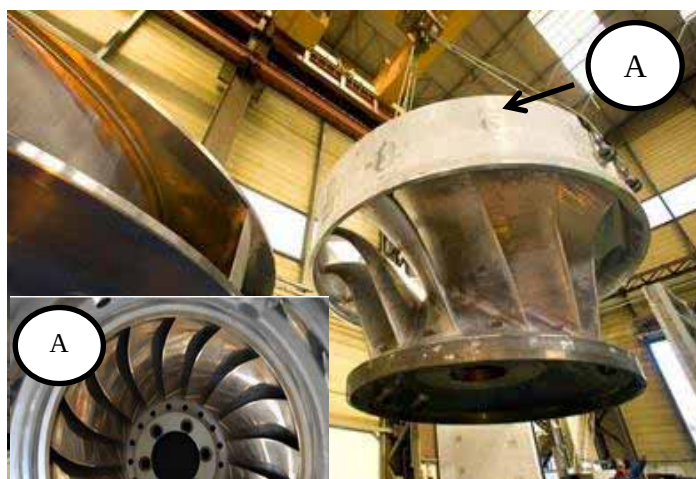
Figura 6– Roda de uma turbina Francis em processo de fabricação
