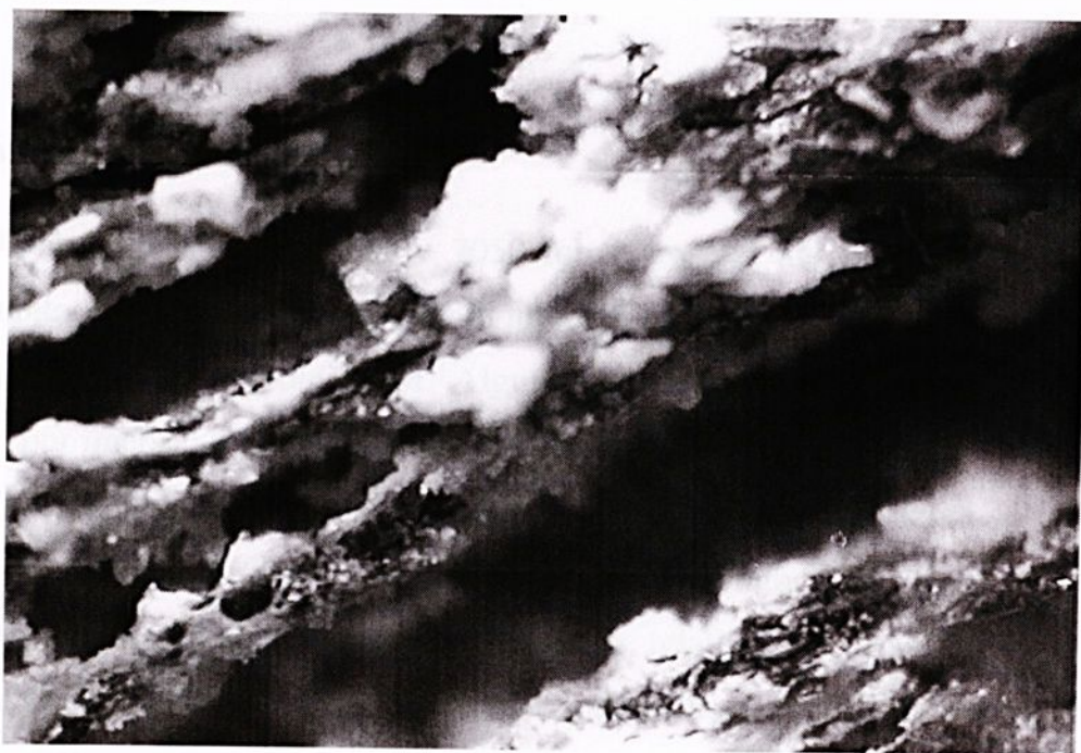
Figura 39- Micrografia ótica da superfície das ligas de Al 2024 após imersão em NaCl 5% na presença de \text{NaNO}_2 0,1M mostrando que a liga sofre corrosão por esfoliação.
