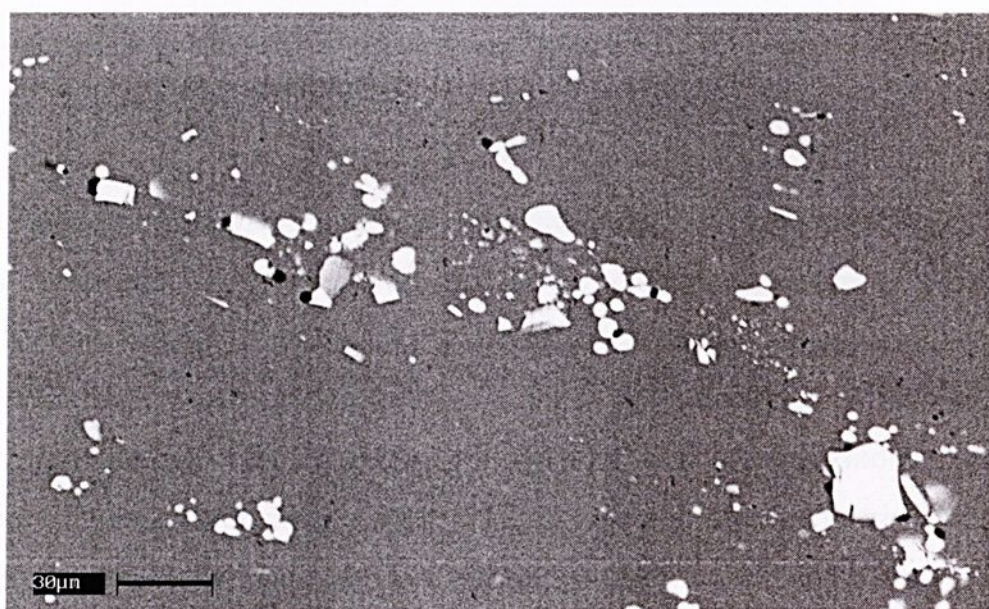
Figura 17- Micrografia da superfície das ligas de alumínio 7050 mostrando a presença de partículas intermetálicas grosseiras.
