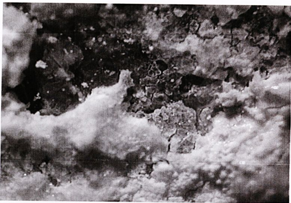
Figura 38- Micrografia ótica da superfície das ligas de Al 7050 após imersão em NaCl 5% na presença de \text{NaNO}_3 0,1M mostrando uma grande quantidade de produtos de corrosão com coloração branca aderidos em sua superfície.
