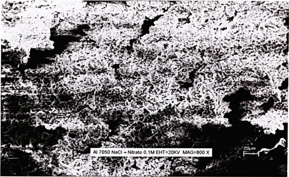
Figura 28- Micrografia da superfície da liga Al 7050 após imersão em NaCl 5% / NaNO 3 0,1M mostrando um depósito volumoso de produtos de corrosão.
