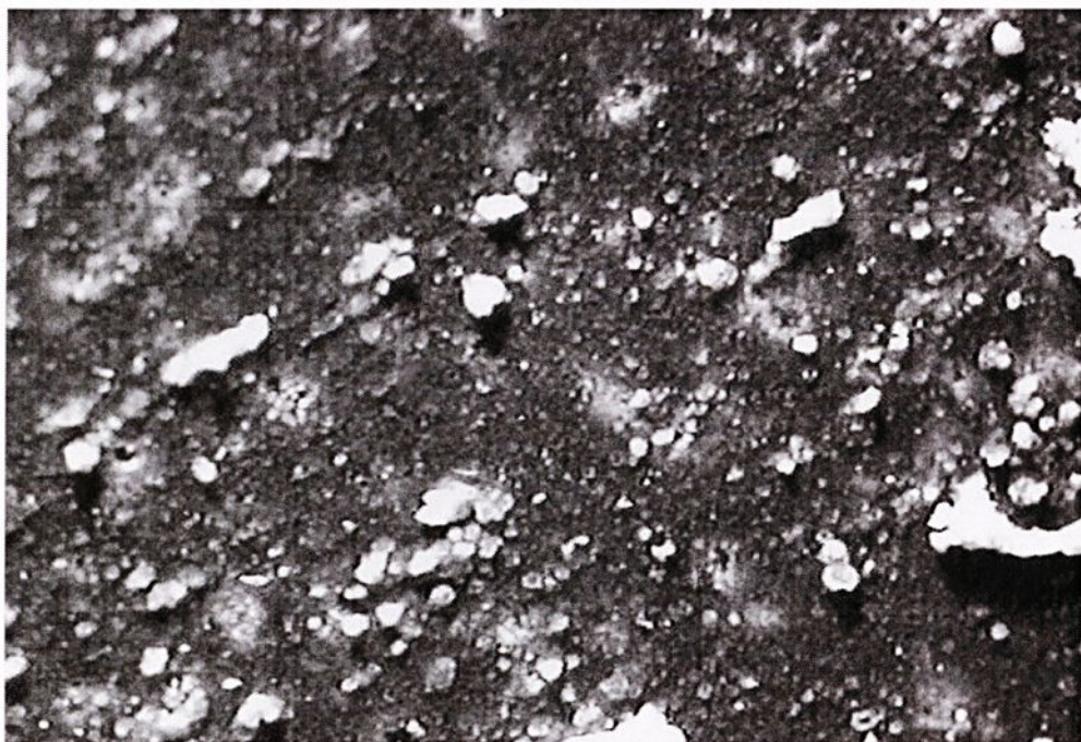
Figura 37- Micrografia ótica da superfície das ligas de Al 2024 após imersão em NaCl 5% na presença de \text{NaNO}_3 0,1M mostrando um aspecto bem poroso da superfície.
