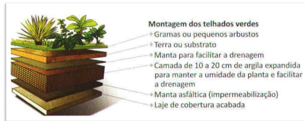
Figura 48- Detalhe teto verde (Fonte: Catálogo da Argila expandida Green, Cinexpan)
