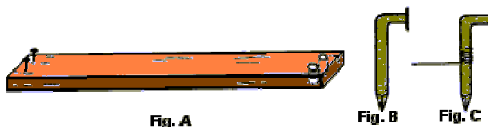
Figura 34: (A) Tábua de madeira furada. (B) Dobragem do prego a 2cm da cabeça. (C) Pregos com barbante enrolado a 5,5 cm da ponta.
