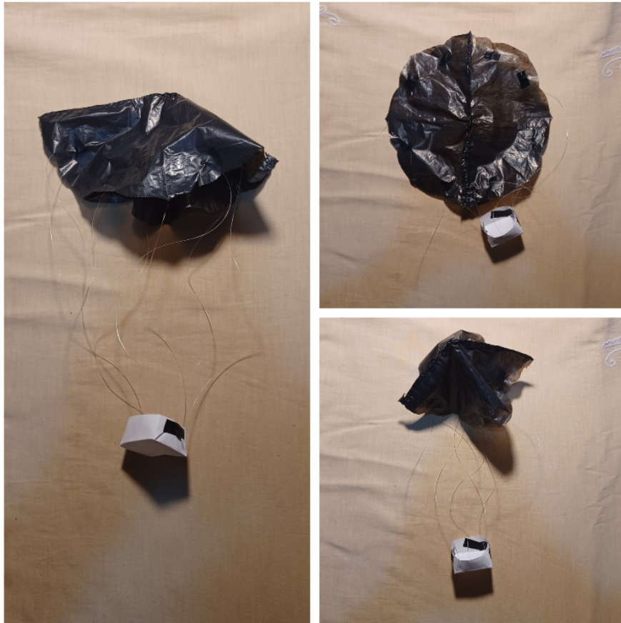
Figura 19: Paraquedas construído com saco de lixo e linha de pesca. No compartimento de papel pode-se colocar variados objetos para demonstração da relação entre a massa e o movimento do paraquedas.
