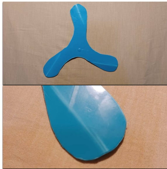
Figura 10: Bumerangue feito a partir de um pote de sorvete. No detalhe, a curvatura das asas, que faz com que haja uma força de sustentação durante o voo.
