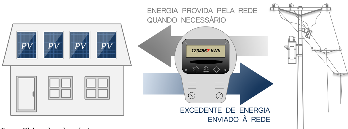
Figura 10 – Medição bidirecional em sistemas de GDFV.
