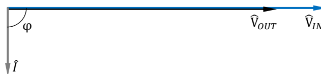
Figura 83 – Diagrama fasorial de compensação pura de potência reativa capacitiva
