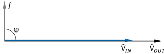
Figura 84 – Diagrama fasorial de compensação pura de potência reativa indutiva.
