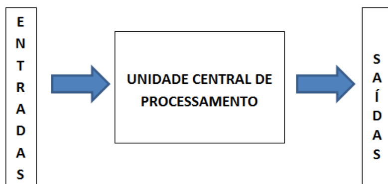
Figura 6: Estrutura básica do CLP.
