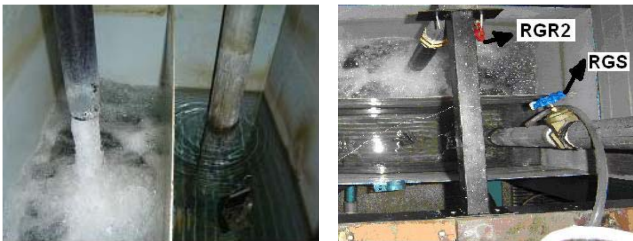
Figura 3.2 – Instalação da placa metálica de separação dos reservatórios de sucção e recalque.
