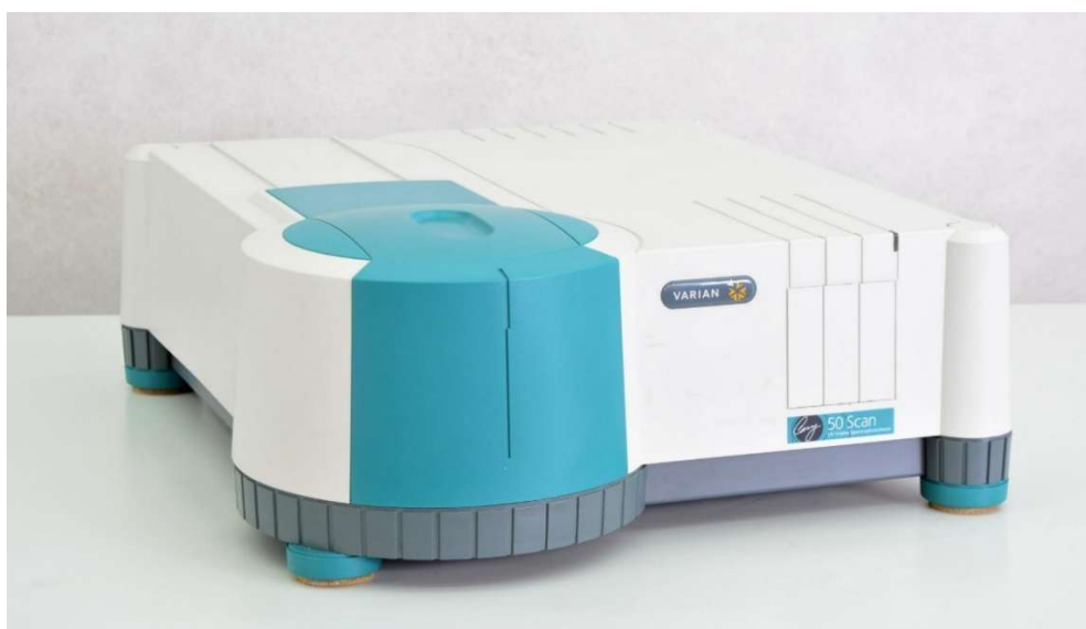
Figura 4 – Espectrofotômetro de fluorescência Varian Cary Eclipse, utilizado para aquisição dos espectros de emissão das amostras cerâmicas luminescentes.
