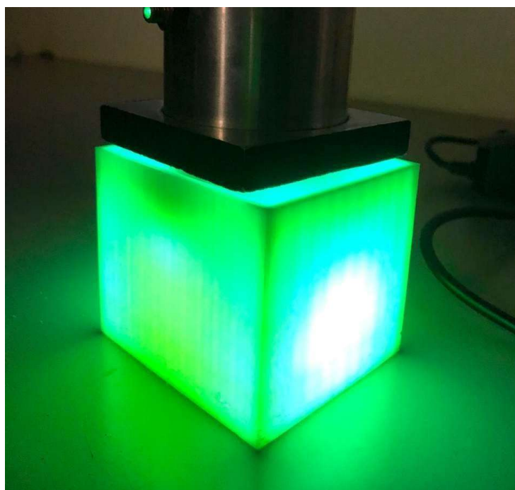
Figura 5 – Caixa branca com amostra de cerâmica verde em seu interior, iluminada por um sistema de LED para análise óptica.
