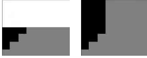
Figura 3.2: Propagação das informações na direção normal ao contorno.
