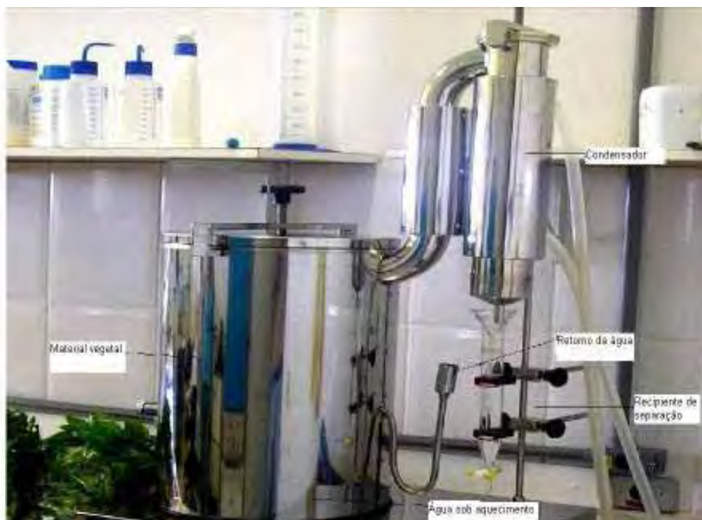
Anexo 3: Aparelho de destilação por arraste de vapor tipo Clevenger marca Marconi, modelo MA480, do Depto de Microbiologia e Imunologia/IBB/UNESP/Botucatu – utilizado para extração dos óleos essenciais.
