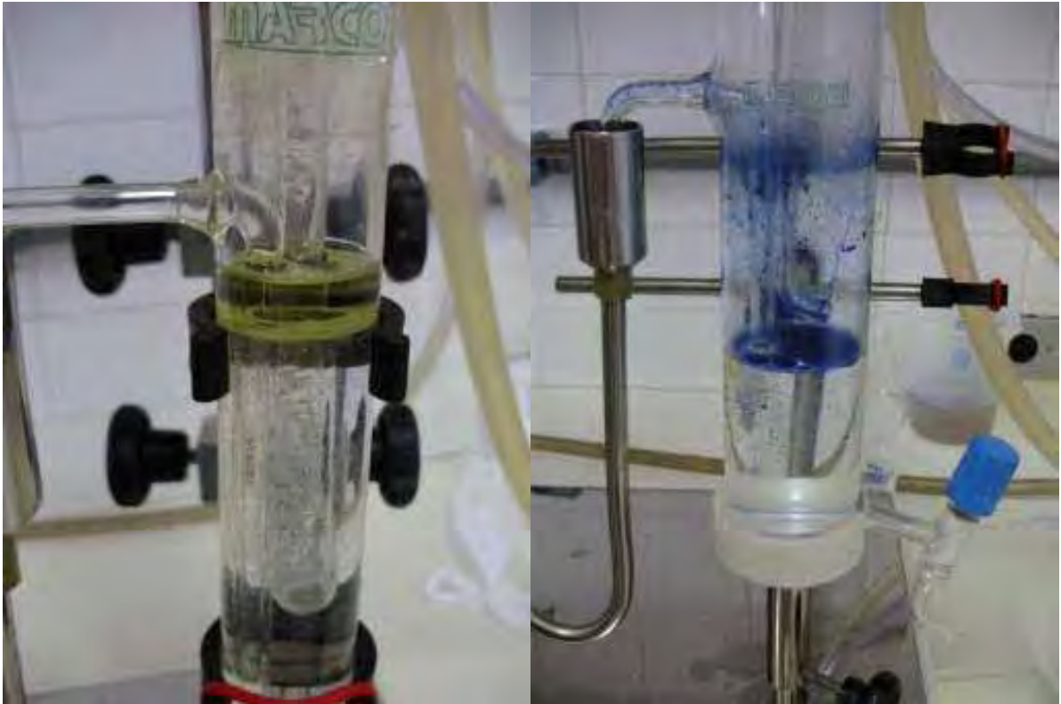
Anexo 1: Extração de óleos essenciais pela metodologia de arraste a vapor a partir de aparelho tipo Clevenger.
