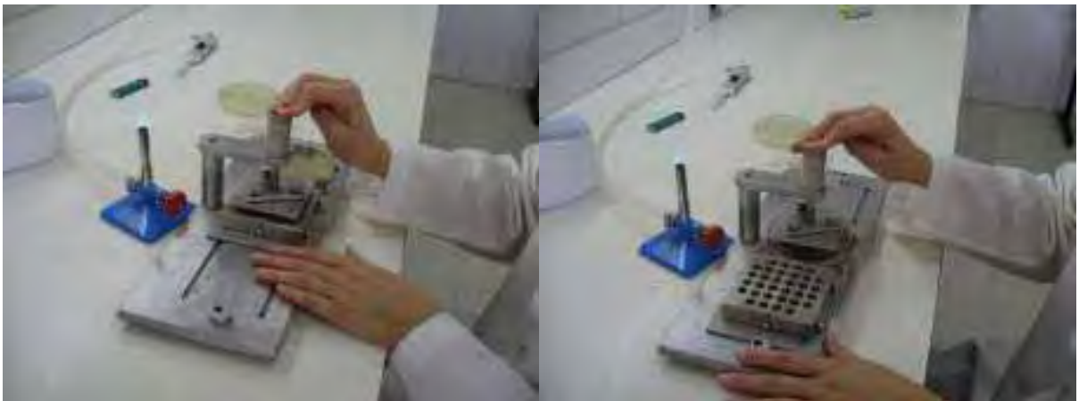
Anexo 2: Multiinoculador de Steer, utilizado para inocular as bactérias em placas utilizadas para a determinação da concentração inibitória mínima.
