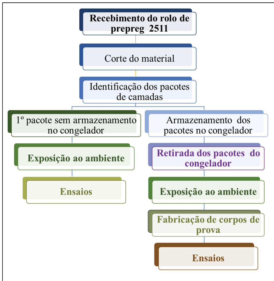
Figura 15: Fluxograma resumido preparação dos corpos de prova desde o recebimento do rolo até os ensaios.
