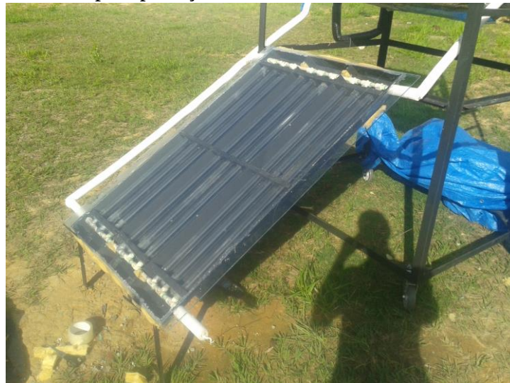
Fotografia 2 – Vidro para proteção do coletor e isolantes térmicos da tubulação
