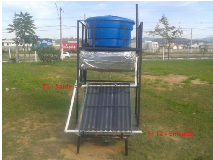
Fotografia 7 – Instalação dos termopares utilizados
