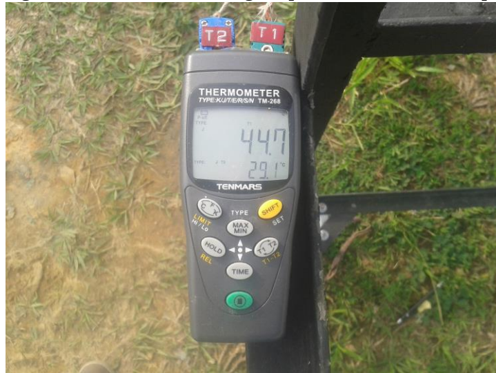
Fotografia 6 – Termômetro digital para leitura dos termopares
