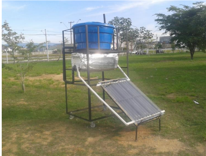
Fotografia 3 – Coletor solar finalizado
