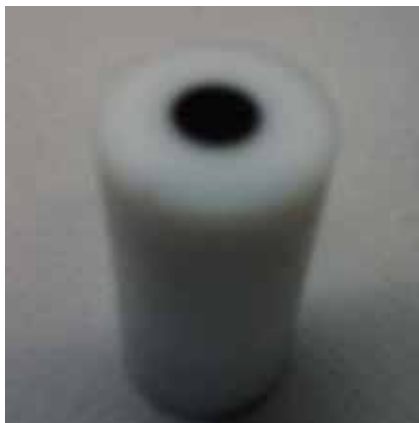
Figura 7 - Eletrodo de trabalho com a camada ultrafina de catalisador.
