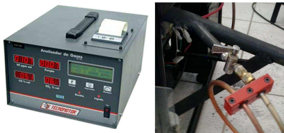
Figura 6 - Analisador de gases Tecnomotor - TM 131 e derivação do coletor de escape
