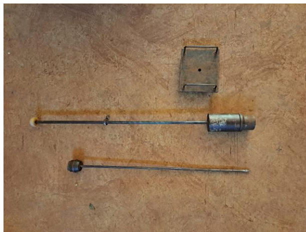
Figura 9. Penetrômetro de impacto.
