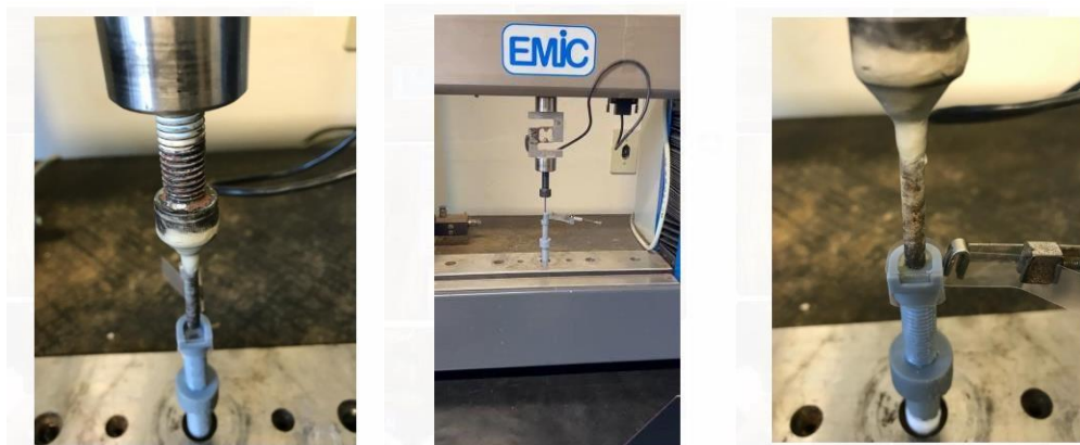
Figura 6. Experimento: parafuso, corpo de prova e resina na máquina de ensaios universal Emic DI 3000
