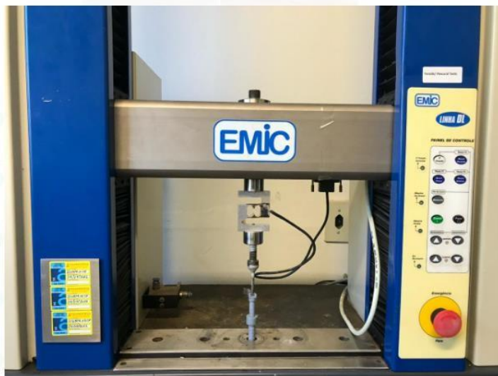
Figura 5. Máquina de ensaios universal Emic DI 3000 (EMIC Equipamentos e Sistemas de Ensaios Ltda., São José dos Pinhais, PR, Brasil)
