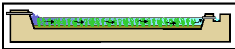
Figura 5: Sistema com plantas submersas (SALATI, 2000 apud CUNHA, 2006)
