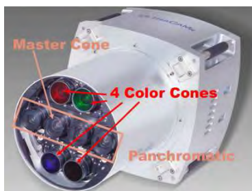
Figura 12 – Câmera Vexcel-UltraCam D. Fonte: gtbibérica 6 (2009).
