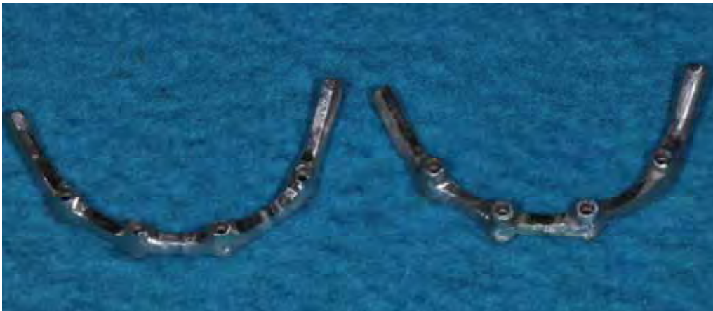
Figura 7. Barras fundidas em Fit Cast Titanium.
