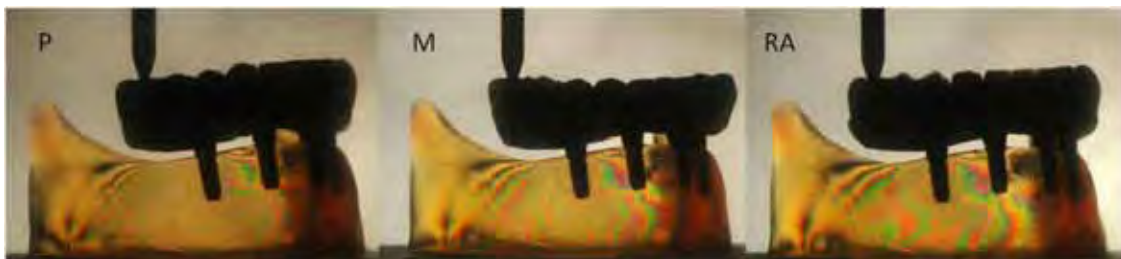
Figura 15. Carregamento axial em molar com implantes retos. P - Porcelana, M - Metal e RA - Resina Acrílica.
