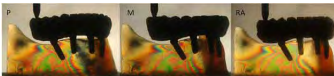
Figura 18. Carregamento axial em molar com implantes inclinados. P – Porcelana, M – Metal e RA – Resina Acrílica.
