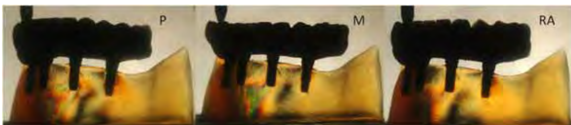
Figura 16. Carregamento axial em molar com implantes retos. Lado contralateral. P - Porcelana, M - Metal e RA - Resina Acrílica.
