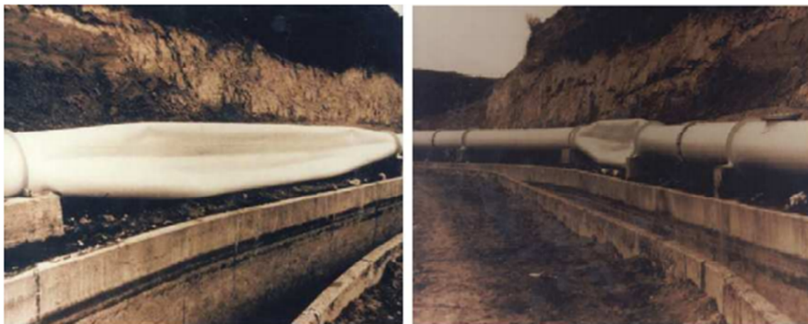
Figura 7. Resultado de golpe de aríete com subpressão na linha de adução. Fonte: Haper International.
