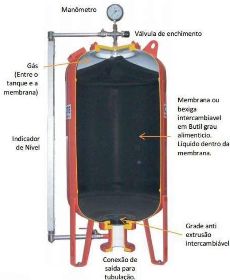
Figura 17. Componentes de um reservatório hidropneumático com bexiga (RHO). Fonte ARI.
