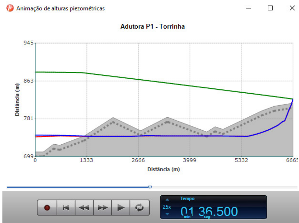
Figura 58. Linha de pressão 6,500 segundos após o início do transiente chegando ao final da adutora.
