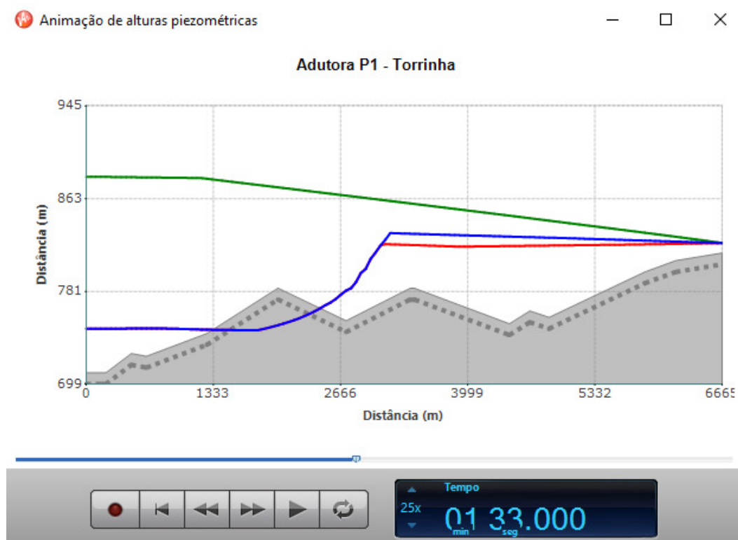
Figura 57. Linha de pressão 3 segundos após o início do transiente.
