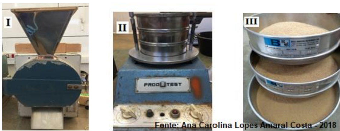
Figura 5 – I - Moagem e classificação das amostras no moinho tipo Willey; II - Agitador de peneiras; III - Granulometria das amostras
