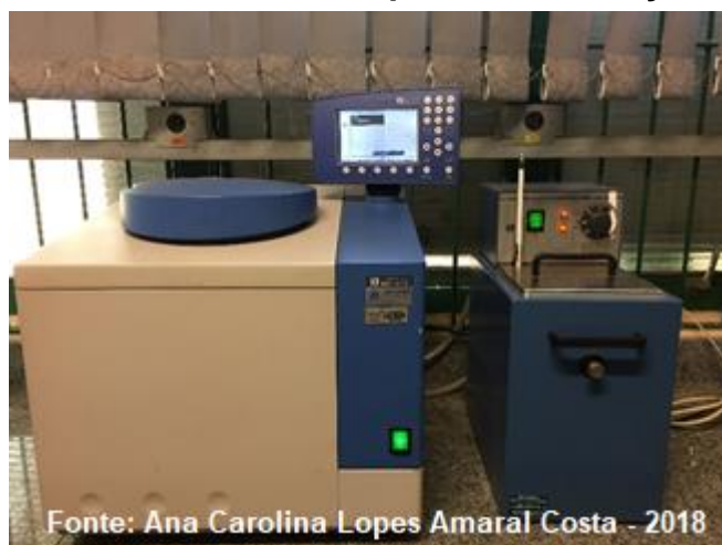
Figura 9 - Calorímetro utilizado para determinação do PCS
