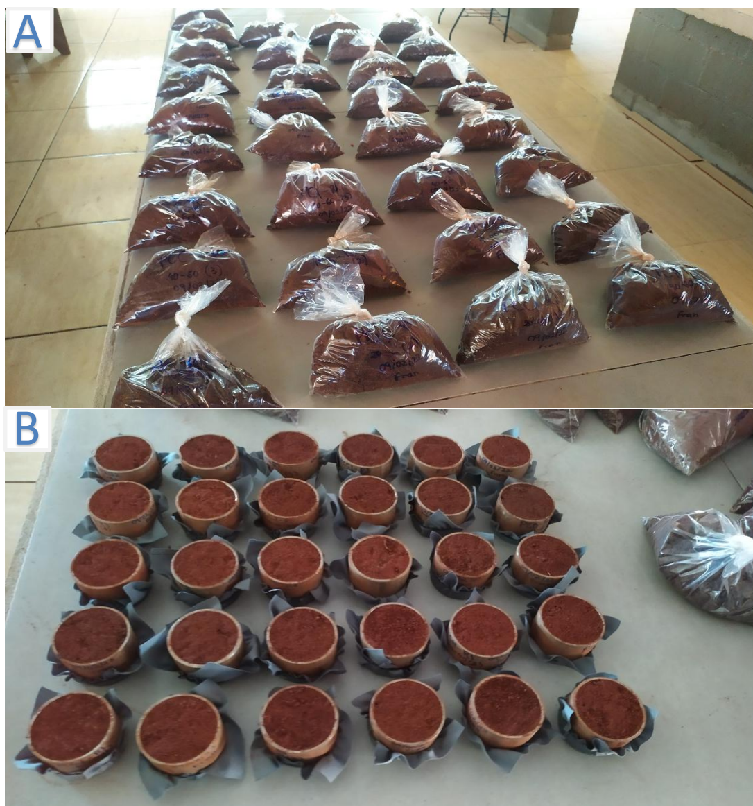
Figura 9. Amostras de solo sendo: (A) amostras destinadas às análises químicas, devidamente identificadas e armazenadas em sacos plásticos; (B) amostras indeformadas dispostas em anéis volumétricos para análises físicas, no Laboratório de Fertilidade do Solo da UNESP, campus de Ilha Solteira.
