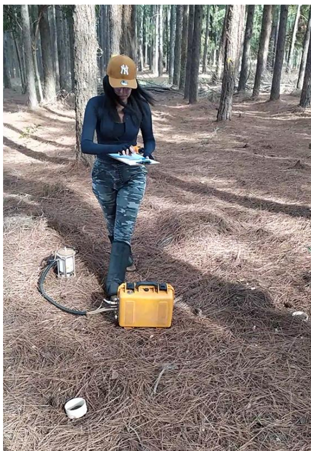
Figura 11. Medição da emissão de CO 2 do solo com o uso do LI-8100 (LI-COR Biosciences), em área de cultivo de Pinus caribaea , no município de Selvíria-MS.
