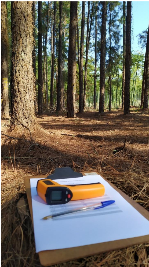
Figura 13. Termômetro a laser infravermelho utilizado para medição da temperatura do solo nos experimentos de Pinus .
