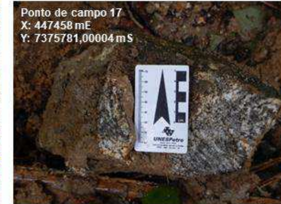
Gnaiss alterado em relevo de meia-encosta, com granulação mais grosseira na Unidade V
