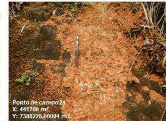
Perfil de Granito alterado na Unidade XVI
