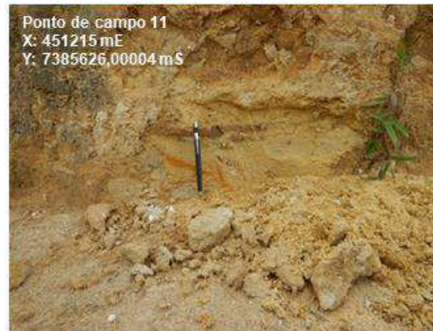
Perfil com argilas e areia média na Unidade Fisiográfica IA.
