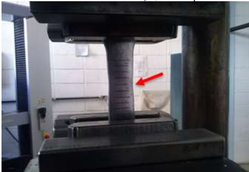
Figura 42 – Corpo de prova de tração, relativo à posição 90°, durante o ensaio de tração. É possível notar o início do fenômeno da estrição, indicado pela seta vermelha.
