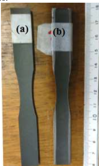
Figura 53 – Comparação entre os corpos de prova sem abaulamento da região de “garra” (a) e com abaulamento da região de “garra” (b), configuração esta utilizada em todos os ensaios válidos.
