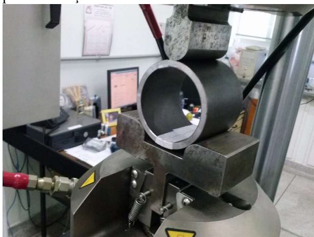
Figura 58 – Dispositivo e trecho de tubo (CDP LS-3) acoplados à máquina de ensaios de fadiga para realização do teste.
