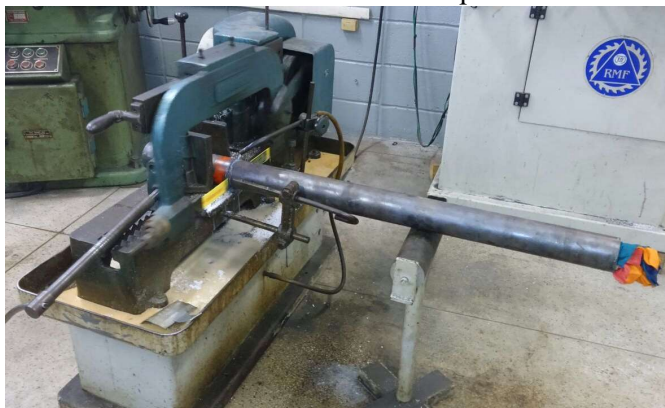
Figura 34 – Tubo de aço API N80 tipo Q sendo seccionado com utilização de uma serra hidráulica da Oficina Mecânica do Departamento de Materiais e Tecnologia da FEG/UNESP.
