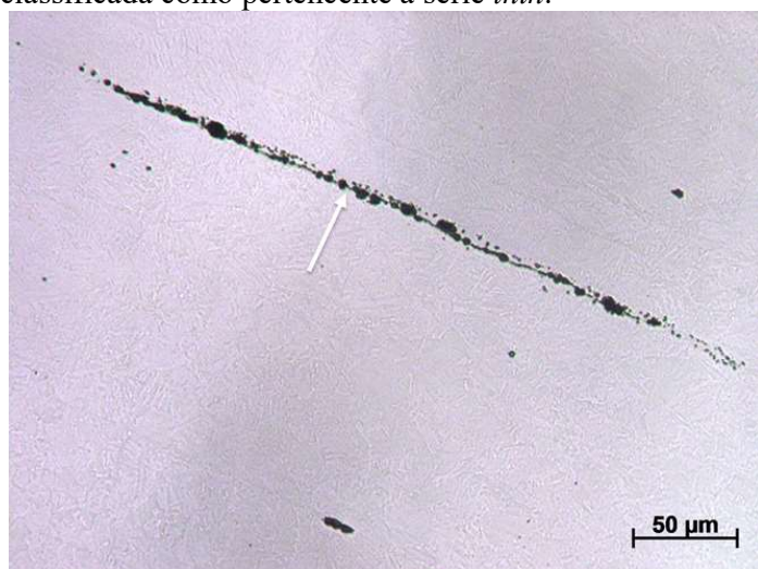
Figura 67 – Amostra retirada da região 90° (micrografia radial longitudinal). É possível notar uma inclusão do tipo alumina, indicada pelas setas brancas. A inclusão deste tipo apresentada é subclassificada como pertencente à série thin .
