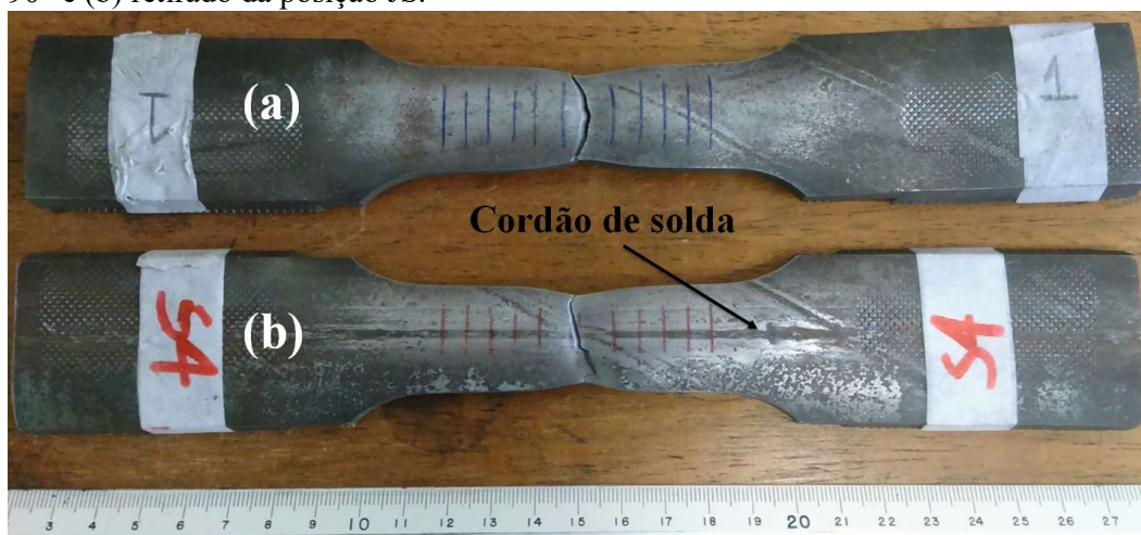
Figura 49 – Aspecto de dois dos corpos de prova após os ensaios, com as fraturas ocorrendo próximo à metade da seção útil do corpo de prova com: (a) corpo de prova retirado da posição 90° e (b) retirado da posição JS.
