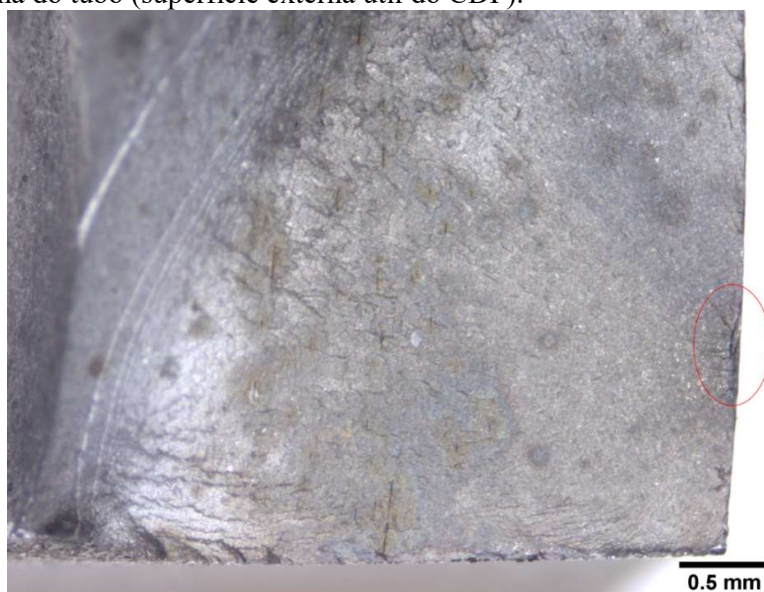
Figura 87 – Macrografia da superfície de fratura do CDP 11-90° obtida com auxílio do estereoscópio. A elipse vermelha indica o ponto de nucleação da trinca e defeito na superfície externa do tubo (superfície externa útil do CDP).
