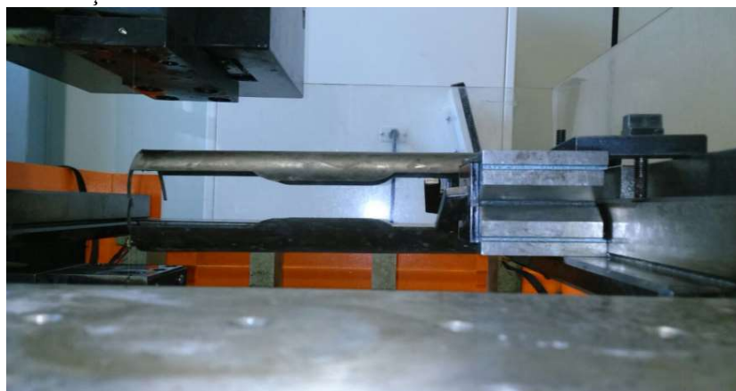
Figura 37 – Usinagem, via processo de eletroerosão a fio, dos corpos de prova utilizados nos ensaios de tração.
