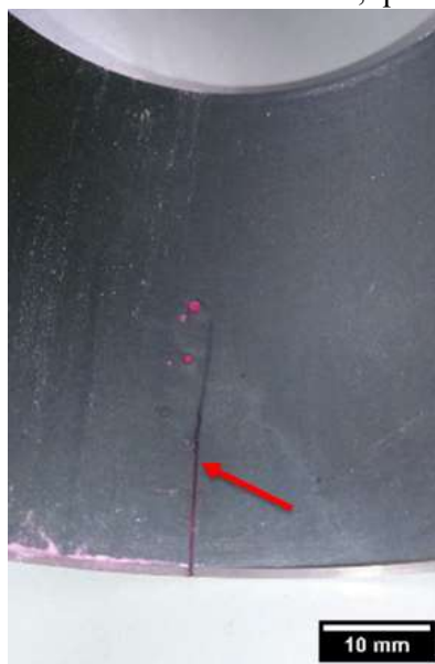
Figura 59 – Trecho de tubo após o ensaio do CDP LS Teste. É possível notar que ocorreu a nucleação e propagação de uma trinca (com aproximadamente 12 mm) de comprimento a partir da extremidade do entalhe, que é indicada pela seta vermelha.
