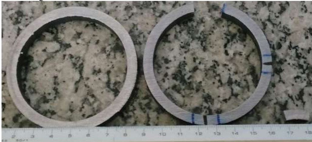
Figura 39 – Anéis de tubos utilizados para retirada de amostras para avaliação de microdureza e análise metalográfica.
