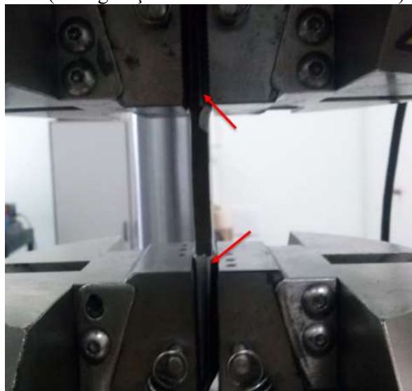
Figura 52 – Corpos de prova fixados na máquina com luvas de alumínio, indicadas pelas setas vermelhas (configuração de todos os ensaios válidos).
