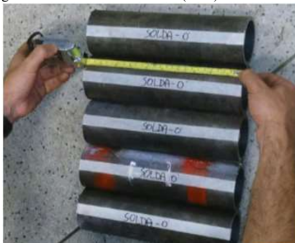
Figura 36 – Trechos de tubo com 250 mm de comprimento durante o processo de identificação das regiões de interesse: solda e 90° (270°).
