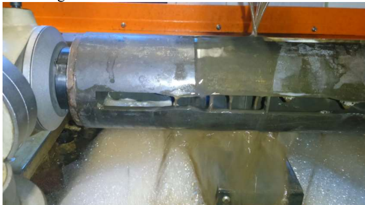
Figura 38 – Usinagem, via processo de eletroerosão a fio, dos corpos de prova utilizados nos ensaios de fadiga axial.
