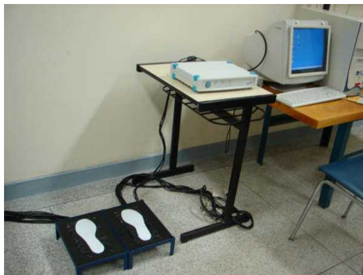
Figura 35 – Detalhe da ponte amplificadora e das plataformas de força.
