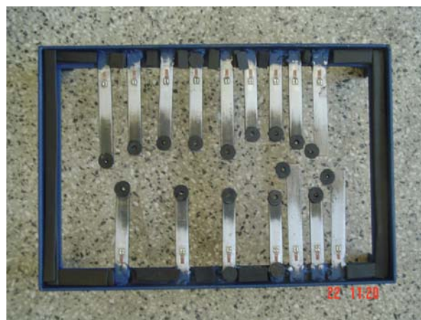
Figura 20 - Detalhe das borrachas coladas nas vigas.
