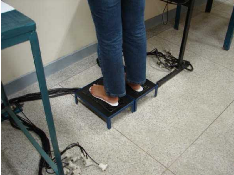
Figura 36 – Demonstração de um sujeito sobre as plataformas de força.
