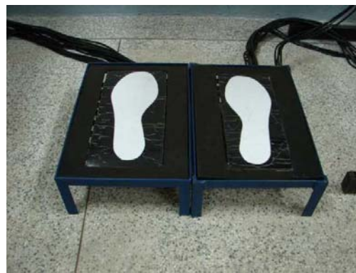
Figura 23 – Detalhe das palmilhas coladas nas plataformas direita e esquerda.
