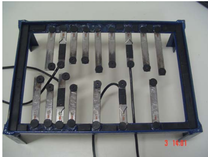
Figura 19 - Início da soldagem dos fios na plataforma direita.
