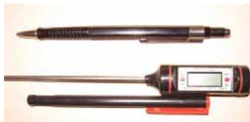
Figura 7. Medidor de temperatura.
