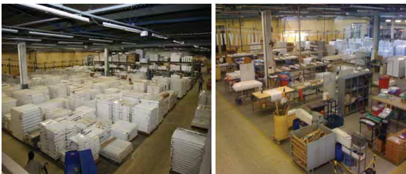
(a) (b) Figura 24 – Redução dos lotes: (a) fotos antes da implementação dos kanbans ; (b) fotos depois da implementação dos kanban
