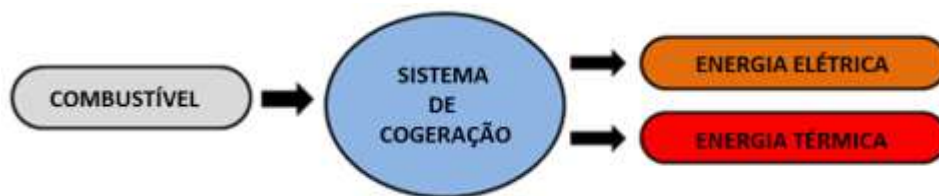
Figura 3 - Sistema de cogeração de energia.
