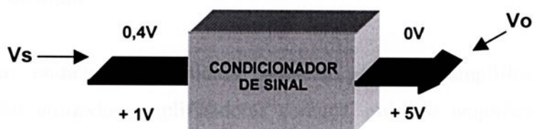
Figura 3.7 – Diagrama de bloco do condicionador de sinal do sensor de temperatura.
