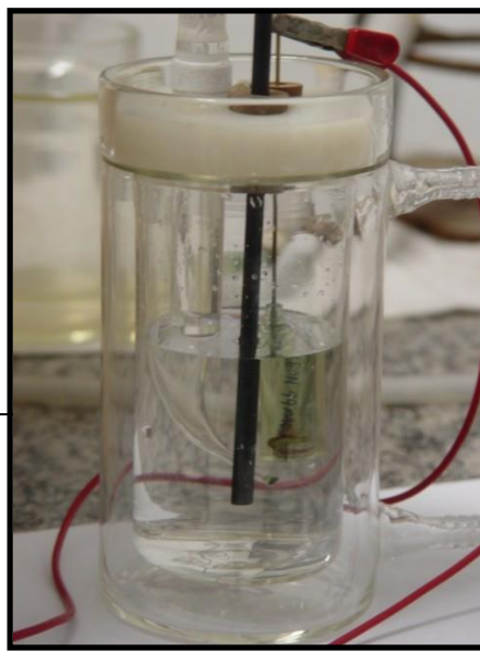
Figura 5 - Eletrodo de trabalho em vista lateral.
