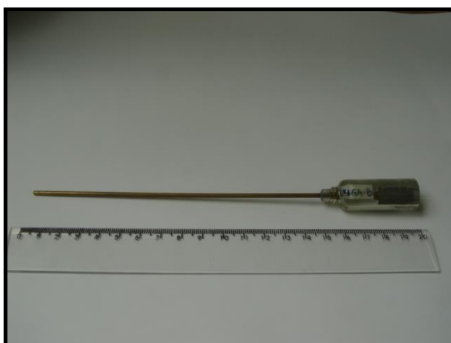
Figura 5 - Eletrodo de trabalho em vista lateral.
