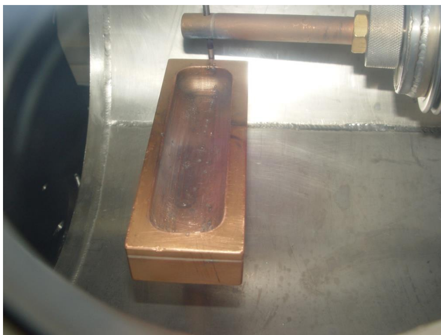
Figura 2 - Detalhe do cadinho de cobre refrigerado a água
