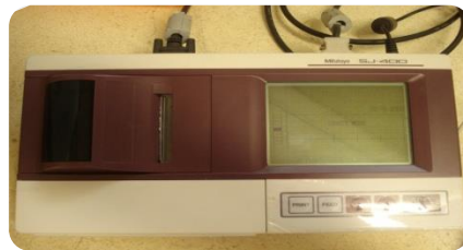
Figura 7. Rugosímetro Surftest SJ 400 – Mitutoyo (Mitutoyo American Corporation)
