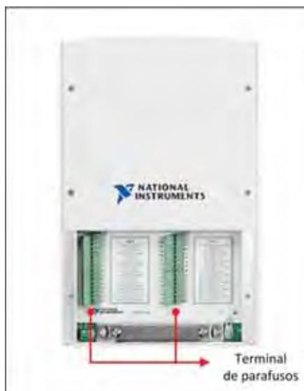
**Figura 32.** Terminal de parafusos no interior da placa de aquisição de dados.
