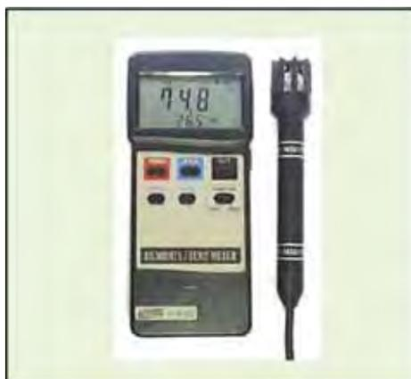
**Figura 28.** Medidor de temperatura e umidade, modelo HRT-152, que tem uma saída serial de dados que pode ser conectado diretamente a uma entrada de comunicação serial no computador.
