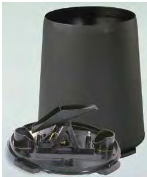
**Figura 3.** Pluviômetro basculante. Na porção inferior da foto está localizado a bscula sua chave magntica posicionada nas extremidade de cada cuba da bscula. O suporte cilndrico, atrs do dispositivo,  para proteo contra detritos e animais.
