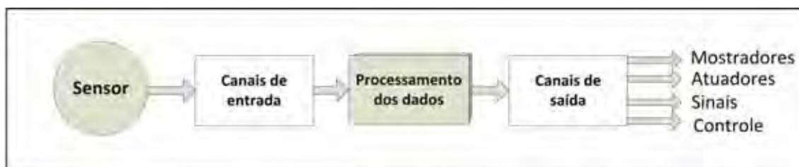
**Figura 1.** Representação sistemática de um processo de medição em diagrama de blocos.
