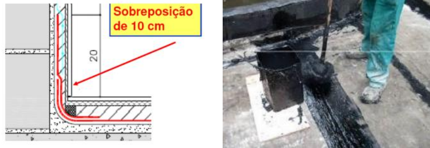
Figura 14 (a) e (b) – Detalhe da sobreposição de mantas asfálticas.
