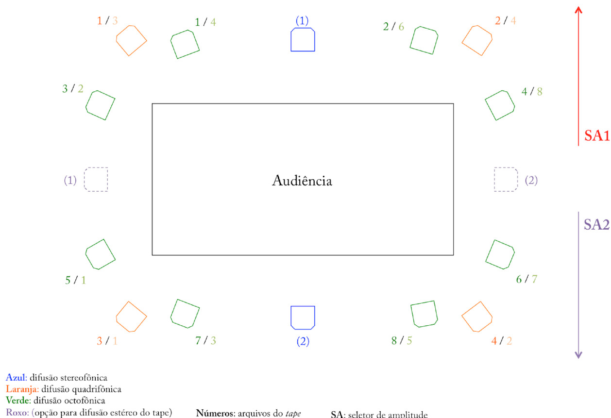
Fig. 5.03 – Representação das possibilidades de montagem dos alto-falantes (instruções da partitura em anexo)
