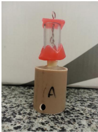
Figura 19: embutimento do pino
