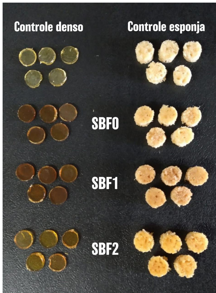
Figura 8 – Amostras de 8mm de diâmetro e 2 mm de altura para as densas e 7 mm de altura para as esponjas, que foram utilizados no ensaio de compressão.
