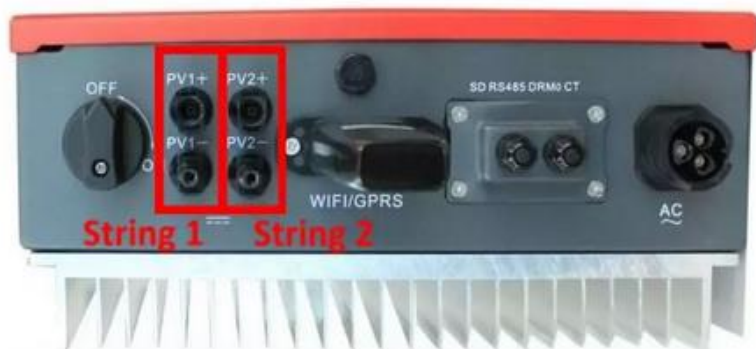
Figura 48 - Inversor com entrada para duas strings e duas MPPTs
