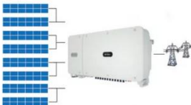
Figura 46 - Inversor com strings em 4 MPPTs diferentes
