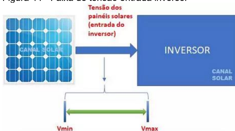
Figura 44 - Faixa de tensão entrada inversor
