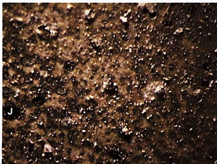
Figura 19 - MO da liga 7010-E mostrando a formação de um filme espesso (I1) e outro fino (I2) e mais aderente. A região mais escura (I3) exibe a superfície corroída do substrato.
