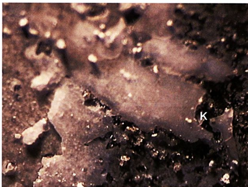
Figura 21 - MO da liga 7010-R exibe a fragilidade de filme (K) formado sobre a superfície da liga.
