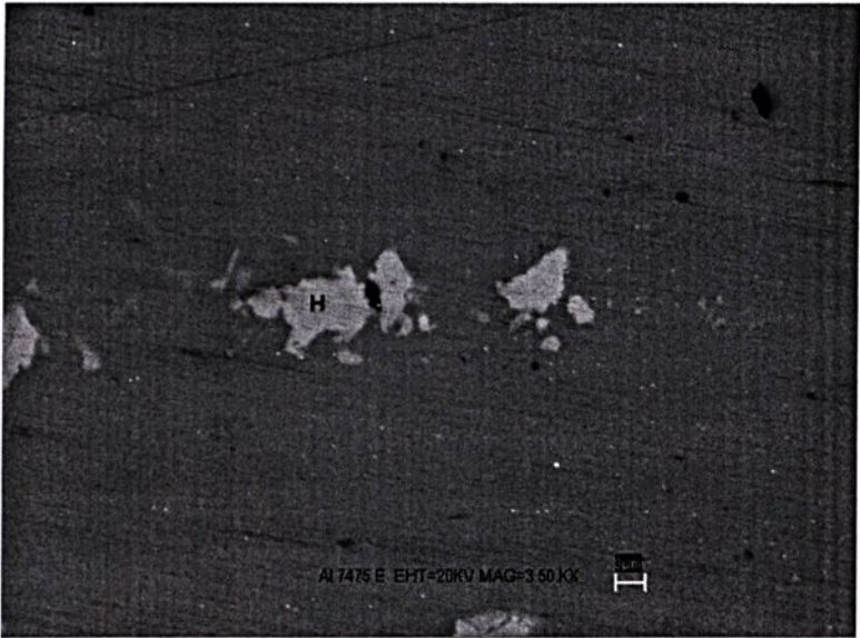
Figura 18 - MEV e EDS da liga 7475-E, após polimento.
