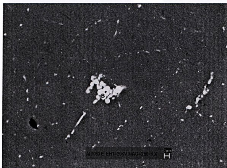
Figura 10 - MEV da liga 7050-E, após polimento.
