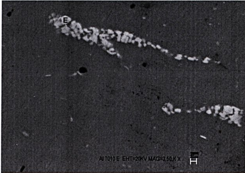
Figura 14 – MEV da liga 7010-E, após polimento.
