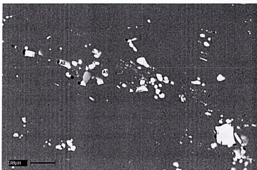
Figura 8- MEV da liga 7050-T7, após polimento. Partículas de \text{Al}_3\text{CuMg}_2\text{Zn} (A1) e \text{Al}_7\text{Cu}_2\text{Fe} (A2).
