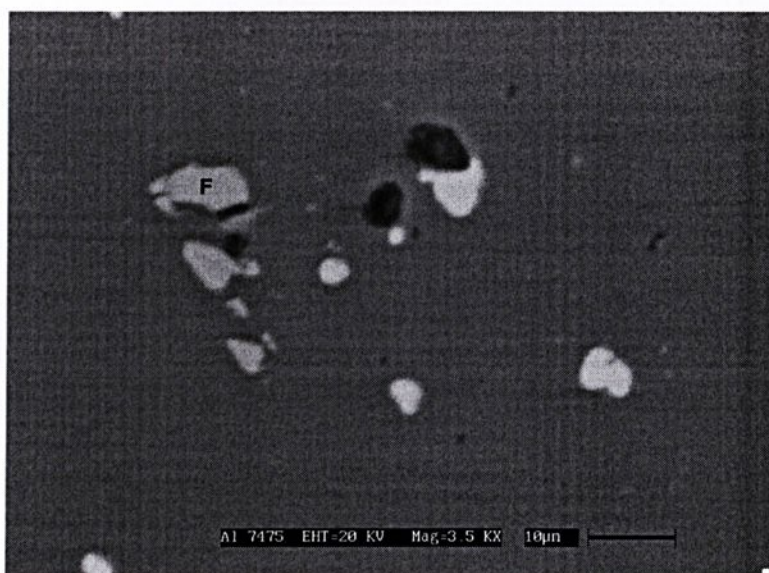
Figura 16 - MEV da liga 7475-T7, após polimento.
