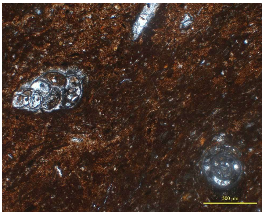
Figura 15 – Microfácies de lamito avermelhado no intervalo 1367,63–1367,66 m, caracterizada por protomatriz lamosa, grãos dispersos de quartzo subangulosos e micas alongadas sem orientação preferencial. Destacam-se foraminíferos bentônicos parcialmente preenchidos por protomatriz lamosa e pirita framboidal.
