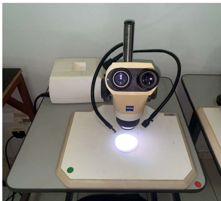
Figura 6 – Imagem do microscópio estereoscópico Zeiss Stemi 2000-C, pertencente à Litoteca UNESPetro (IGCE/UNESP).
