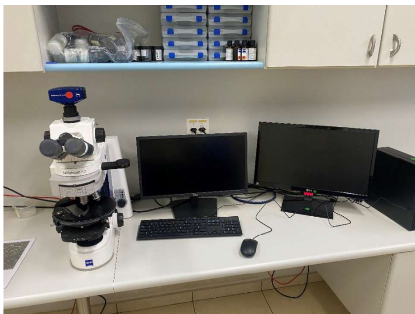
Figura 7 – Imagem do microscópio óptico de luz transmitida Zeiss Axio Imager A2, equipado com câmera digital de alta resolução, no Laboratório de Microscopia Óptica e Fotomicrografia (LMOF) do UNESPetro (IGCE/UNESP).
