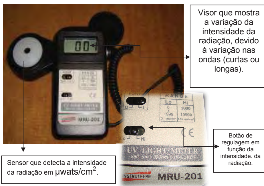
Figura 3. Aparelho usado para medir a intensidade da radiação no laboratório e no campo.
