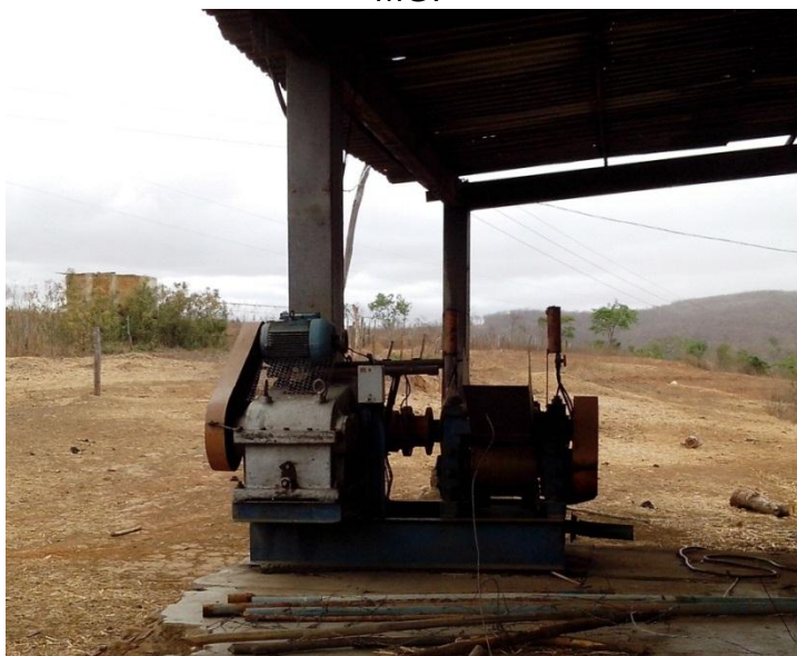
Figura 30 - Moenda de um terno e alimentação manual da agroindústria Sabiá, Salinas-MG.
