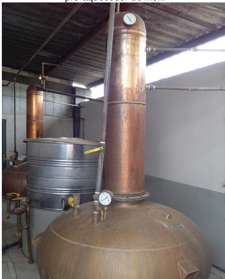
Figura 36 - Sala de Destilação da agroindústria Sabiá, alambique simples de cobre e pré-aquecedor de inox.
