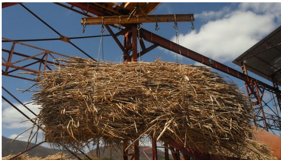
Figura 28 - Sistema de hilo para alimentação das esteiras carreadoras da moenda na Agroindústria Seleta, Boazinha e Antônio Rodrigues, Salinas-MG.
