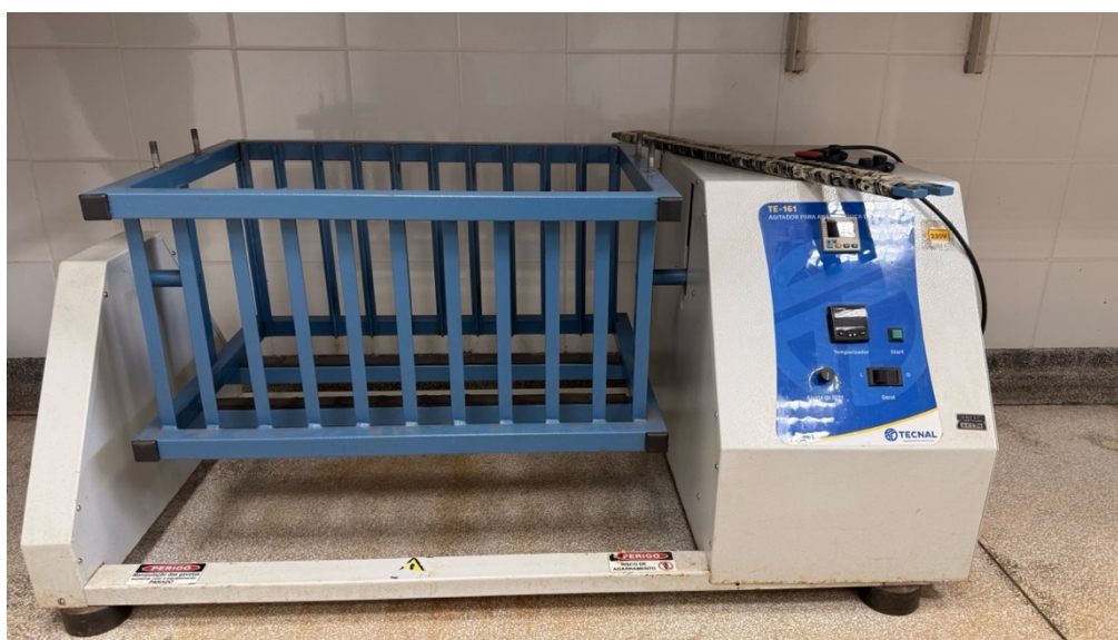
Figura 11. Agitador utilizado para o processo metodológico de correção da quantidade de areia.
