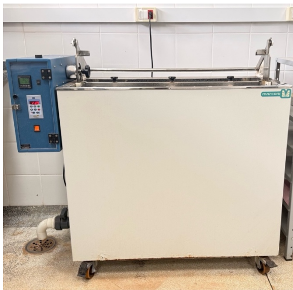
Figura 5. Tanque de agitação úmida utilizado no processo metodológico para obter o índice de estabilidade dos agregados.
