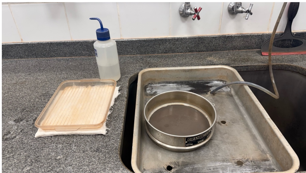
Figura 6. Ferramentas utilizadas para transferência do material retido na peneira de 0,250 mm para o béquer.
