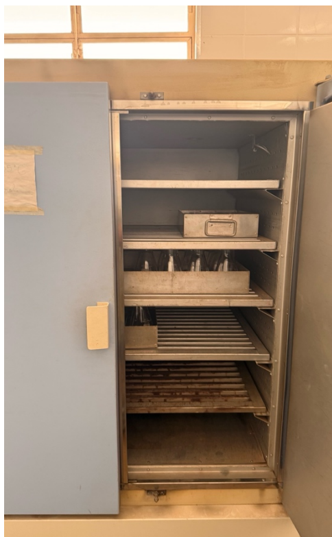
Figura 7. Estufa utilizada no processo metodológico para obter valores do índice de estabilidade dos agregados.
