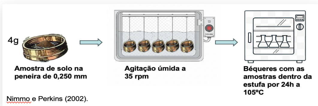
Figura 4. Esquema elaborado pelo autor do presente estudo, sobre o processo metodológico de Nimmo e Perkins (2002) para obter valores do índice de estabilidade dos agregados.
