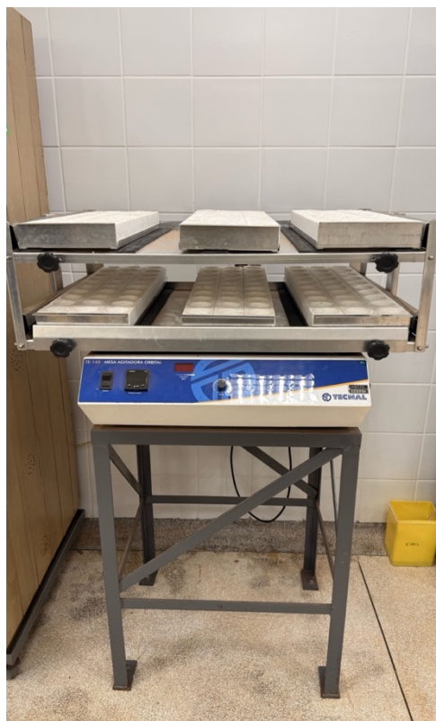
Figura 2. Mesa agitadora orbital utilizada no processo metodológico para obter valores de carbono orgânico do solo.
