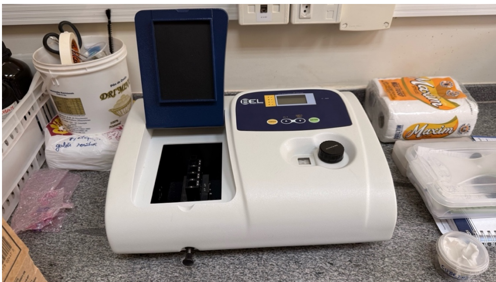
Figura 3. Espectrofotômetro utilizado no processo metodológico para obter o valor de carbono orgânico do solo.
