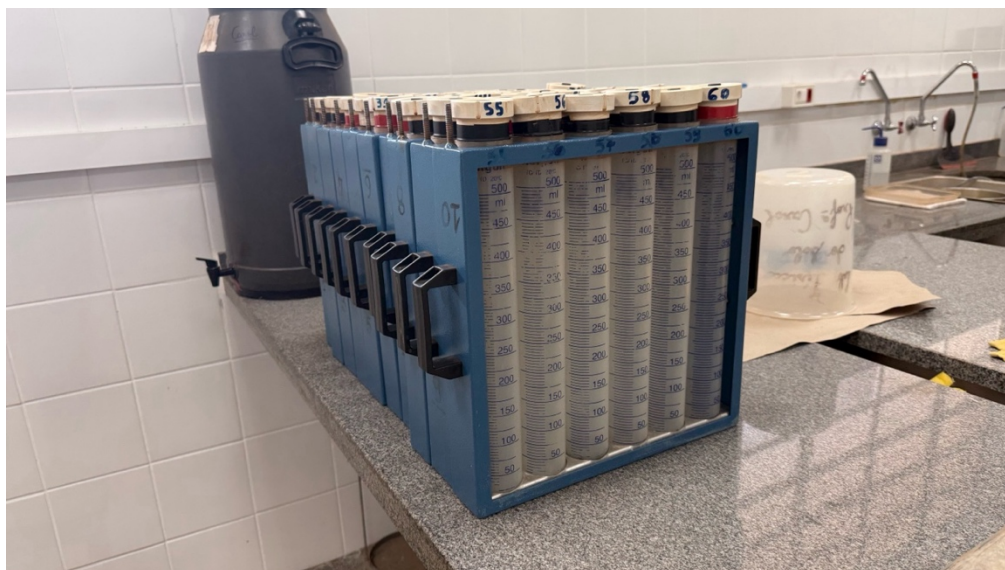
Figura 10. Equipamento utilizado para acoplar provetas ao agitador.
