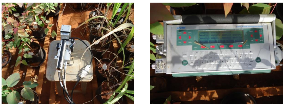
Figura 3. Detalhe do IRGA utilizado na análise em cana-de-açúcar e eucalipto.
