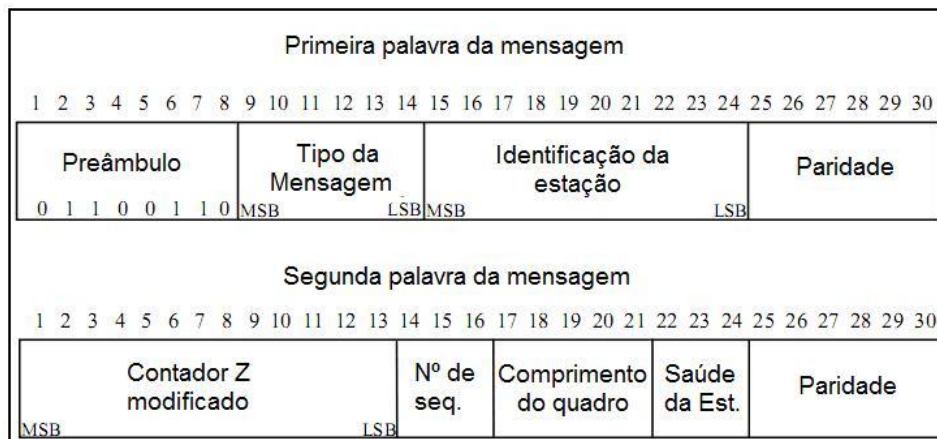
Figura 22: Cabeçalho da mensagem RTCM 2.3 com suas duas primeiras palavras. Fonte:(DALBELO, 2010).
