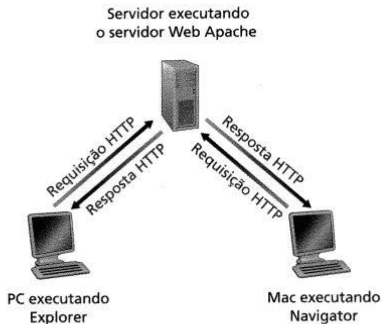
Figura 3: Mensagens de requisição e respostas HTTP (KUROSE J. F. E ROSS, 2005).
