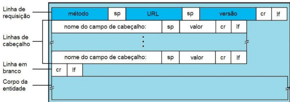
Figura 4: Formato geral de uma mensagem de requisição (KUROSE J. F. E ROSS, 2005).
