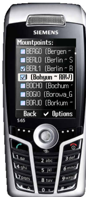
Figura 16: Dispositivo, que roda o componente NtripClient, mostrando em tela alguns mountPoints de uma Sourcetable (GMBH, 2010).
