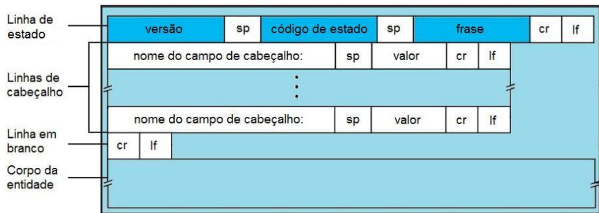
Figura 6: Formato geral de uma mensagem de resposta (KUROSE J. F. E ROSS, 2005).
