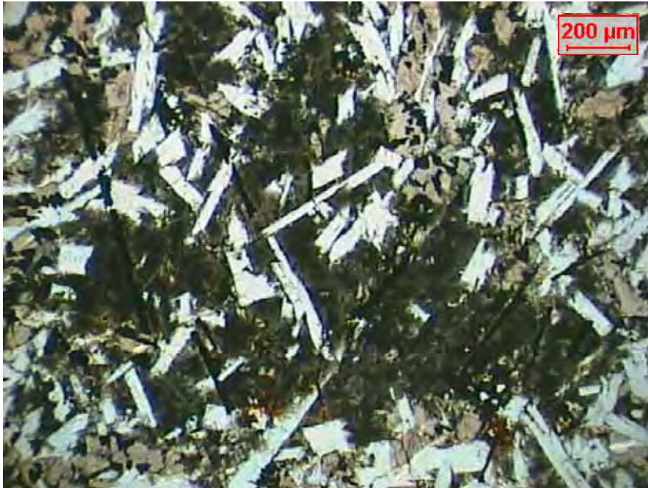
Foto IV.3 – Fotomicrografia de uma amostra coletada ao sul de Ribeirão Preto, exibindo textura intersertal, com cristais de plagioclásio ripiformes corroídos pela mesóstase, além de cristais prismáticos e acastanhados de piroxênio e minerais opacos subhedrais. Nicóis cruzados.
