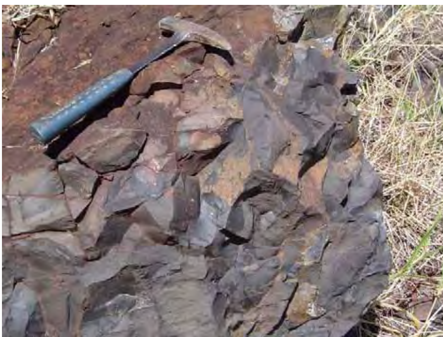
Foto IV.1 – Afloramento próximo à cidade de Ribeirão Preto, com basalto maciço, hipovítreo, coloração negra e fraturas conchoidais.
