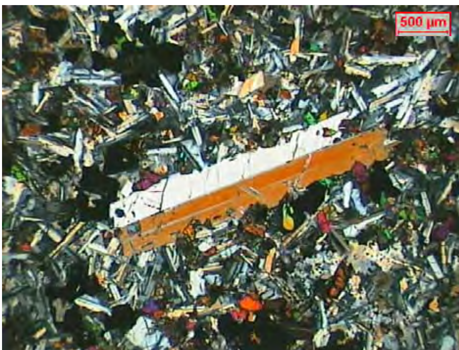
Foto IV.2 – Fotomicrografia de uma rocha com textura intergranular levemente porfírica em amostra coletada próximo a Ribeirão Preto, onde cristal euhédrico de plagioclásio, com bordas parcialmente corroídas (cor clara), encontra-se associado a uma trama constituída por cristais ripiformes de plagioclásio, em cujos interstícios são observados grãos intersticiais de clinopiroxênio (cor acastanhado), além de uma mesóstase microgranular e cristais euhedrais de minerais opacos. Nicóis cruzados.
