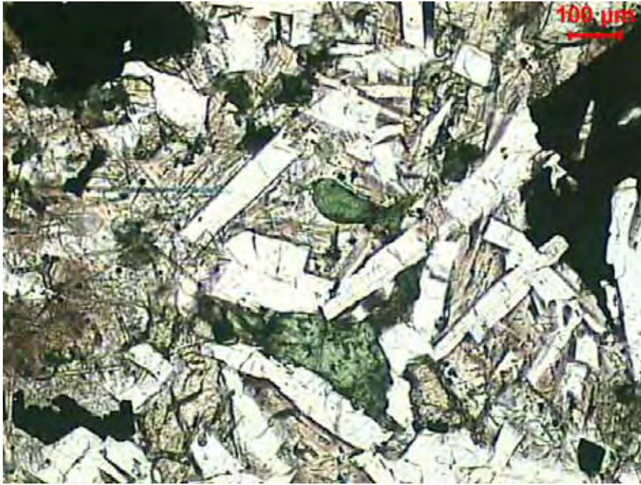
Foto IV.6 - Fotomicrografia de cristais pseudomorfos, esverdeados, de olivina, entre cristais ripiformes de plagioclásio, acastanhados subhedrais de piroxênio, cristalitos e mesóstase microcristalina.
