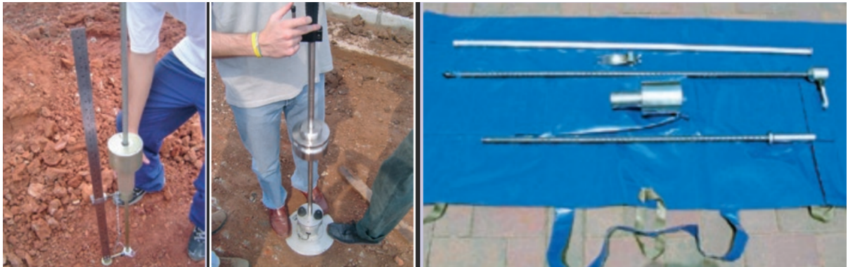
Figura 5.0 - Exemplo de equipamentos DCP de avaliação estrutural expedita de subleitos e camadas de solo.
