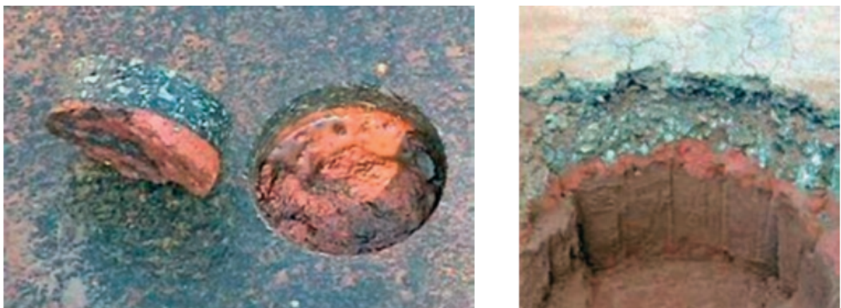
Figura 4.0 - Exemplos de extração de corpos-de-prova e de poços de sondagem de pavimentos em uso.
