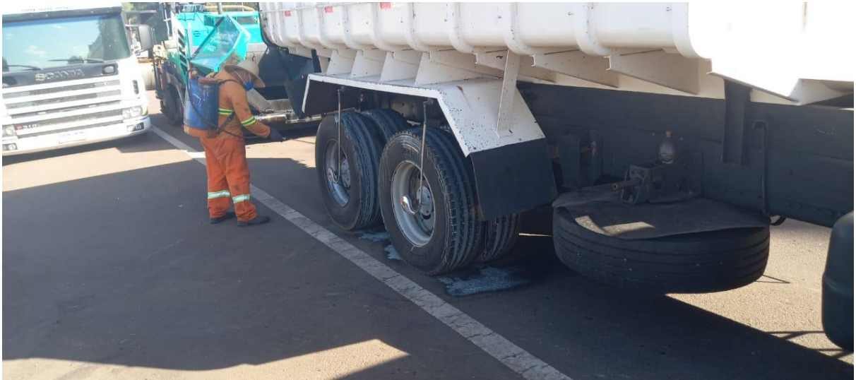
Figura 12 - Aplicação do antiaderente de pneu remocil 270.
