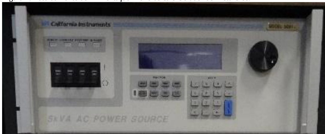
Figura 7: Foto da Fonte de Alimentação Monofásica e Gerador de Distúrbios.
