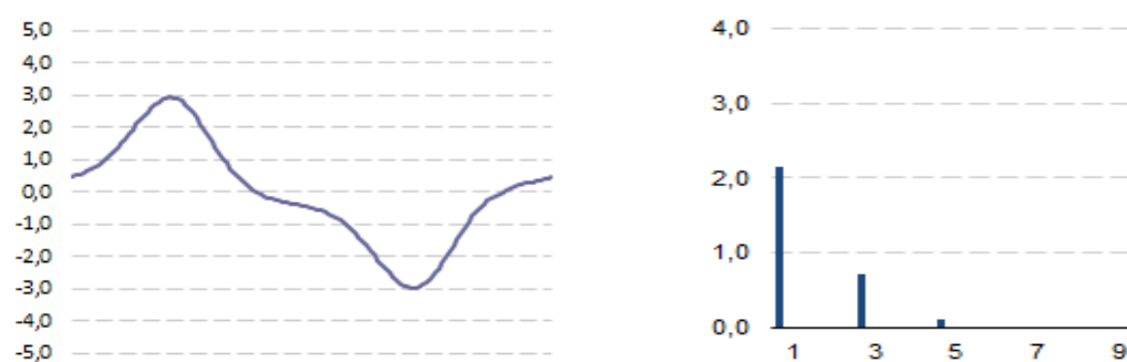
Figura 89: Corrente e espectro harmônico pelo TC4.
