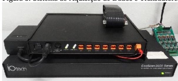
Figura 8: Sistema de Aquisição de Dados e Transdutores de Corrente.
