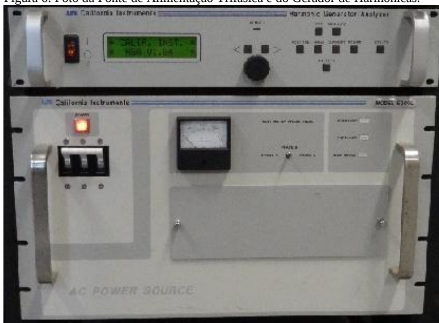
Figura 6: Foto da Fonte de Alimentação Trifásica e do Gerador de Harmônicas.
