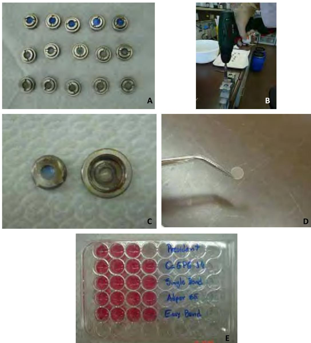
Figura 10 - Desmontagem do sistema: a) *inserts* removidos das câmaras; b) corte da parte central da rede; c) *insert* aberto; d) detalhe da rede cortada, região central utilizada para o teste de viabilidade celular; e) células armazenadas em meio de cultura antes do teste de MTT.
