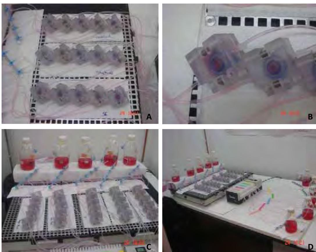
Figura 8 - Montagem do sistema: a) Câmaras montadas no sistema; b) sistema de tubos de difusão; c) sistema conectado às garrafas de meio de difusão; d) sistema montado.
