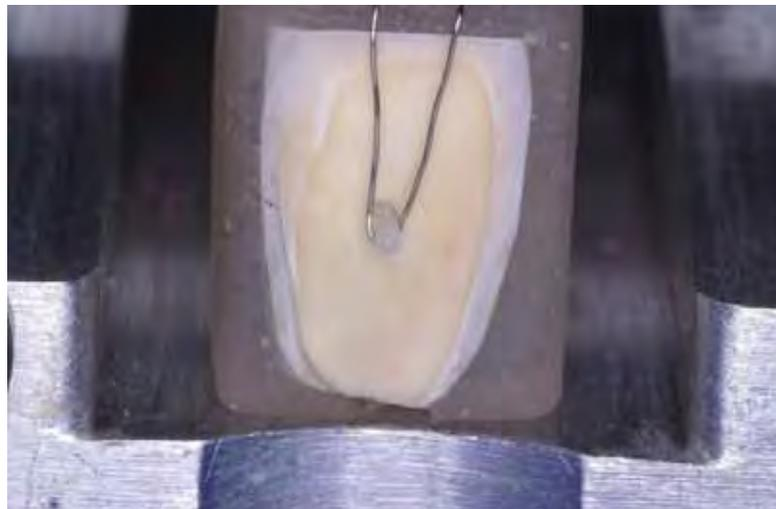
Figura 3 –Cdp posicionado para ensaio de microcisalhamento.
